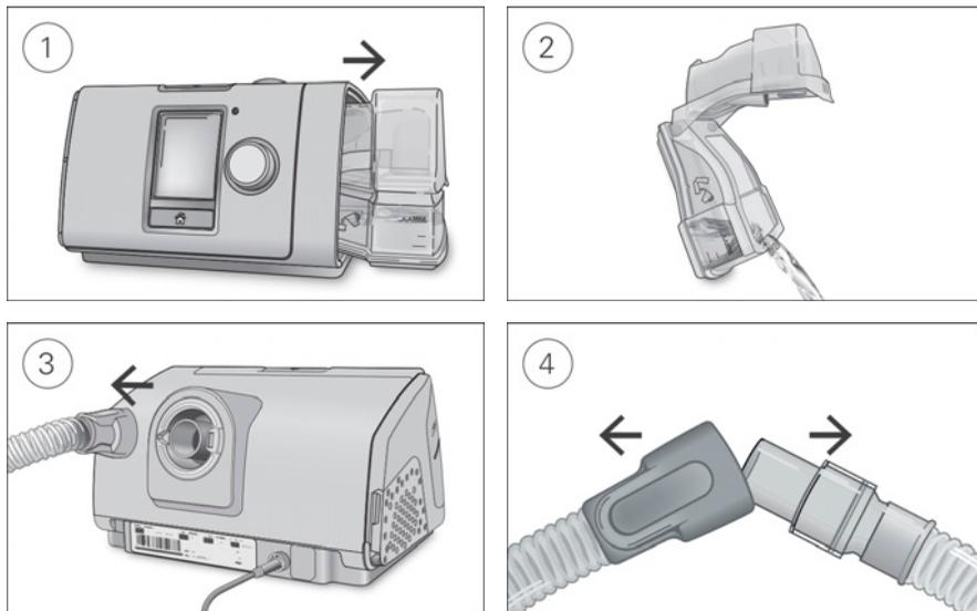
1. Segure o reservatório de água no topo e na base, pressione-o gentilmente e retire-o do dispositivo.
